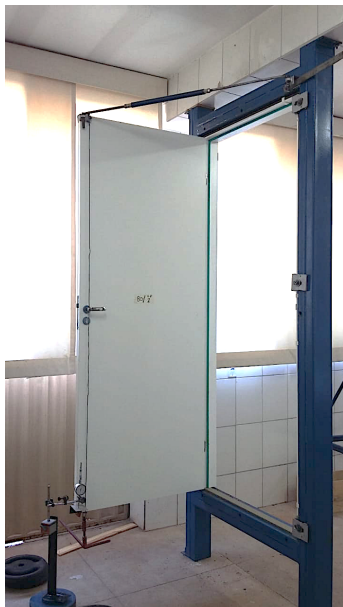
Figura 2 – Corpo de prova instalado para ensaio de resistência ao carregamento vertical.
