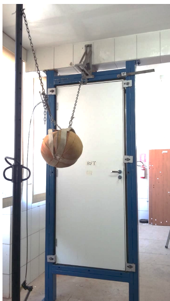
Figura 4 – Corpo de prova instalado para ensaio de resistência aos impactos de corpo mole.
