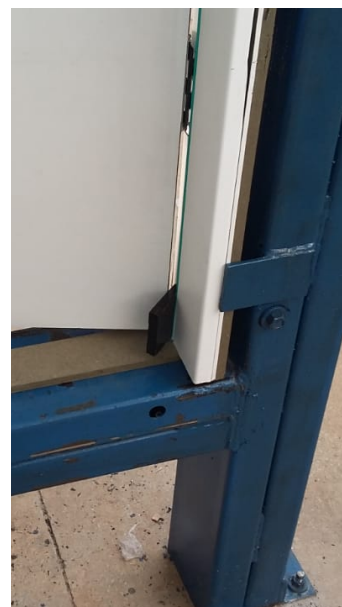
Figura 9 – Corpo de prova instalado para ensaio de resistência ao fechamento brusco com obstrução.
