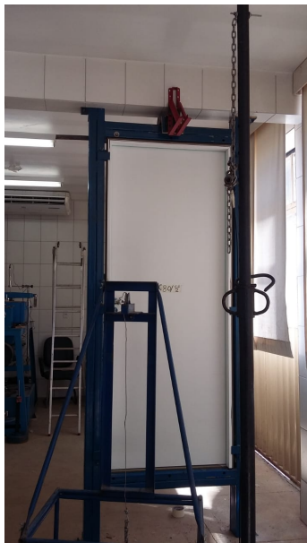
Figura 6 – Corpo de prova instalado para ensaio de resistência ao fechamento brusco.
