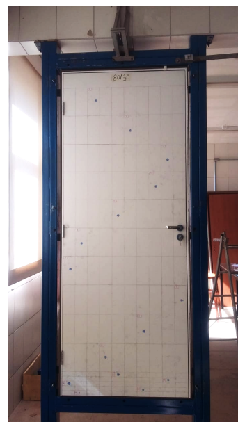
Figura 5 – Corpo de prova instalado para ensaio de resistência aos impactos de corpo duro.
