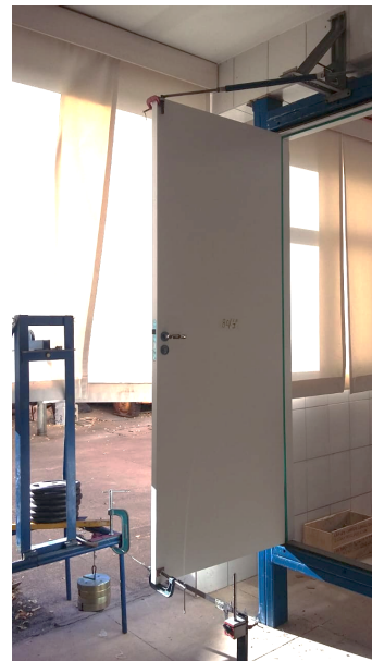
Figura 3 – Corpo de prova instalado para o ensaio de resistência ao esforço torsor.
