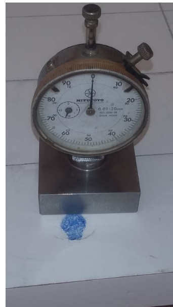
Figura 7 – Equipamento para medição da profundidade das mossas do ensaio de corpo duro.
